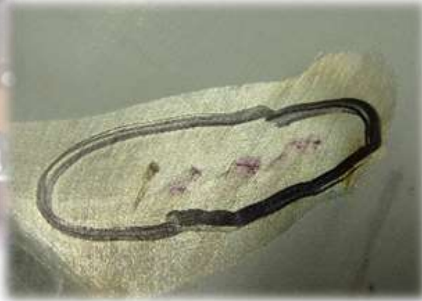
Défaut mis en évidence après ressuage
